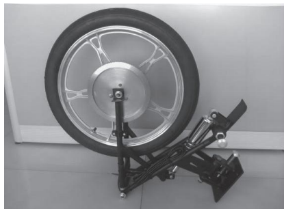
图 5-1-1 接触式第五轮仪
