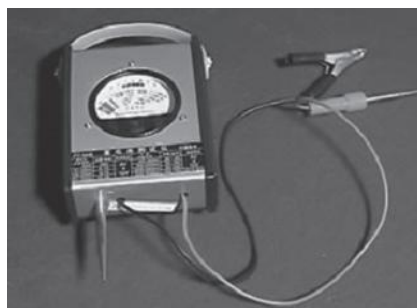
图 1-3-12 用高率放电计检查蓄电池的放电程度
