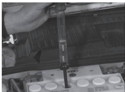
图 1-3-11 用密度计测量电解液的相对密度
