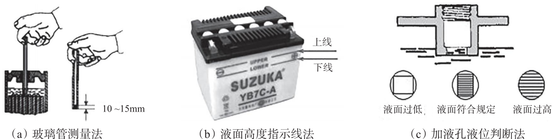
图 1-3-10 蓄电池液面高度检查法
