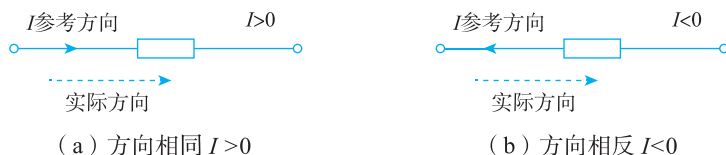
图 1-5 电流参考方向与它的实际方向间的关系
