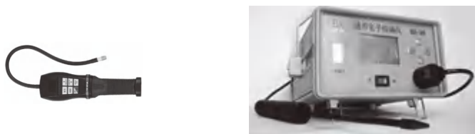
(b) 通用冷媒检漏仪 [适应于普通冷媒（如 R22）和环保新冷媒（如 R134a、R407c、R404a、R410 等）]
