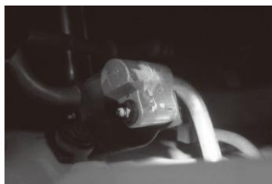
(b) 照射时显现漏点
