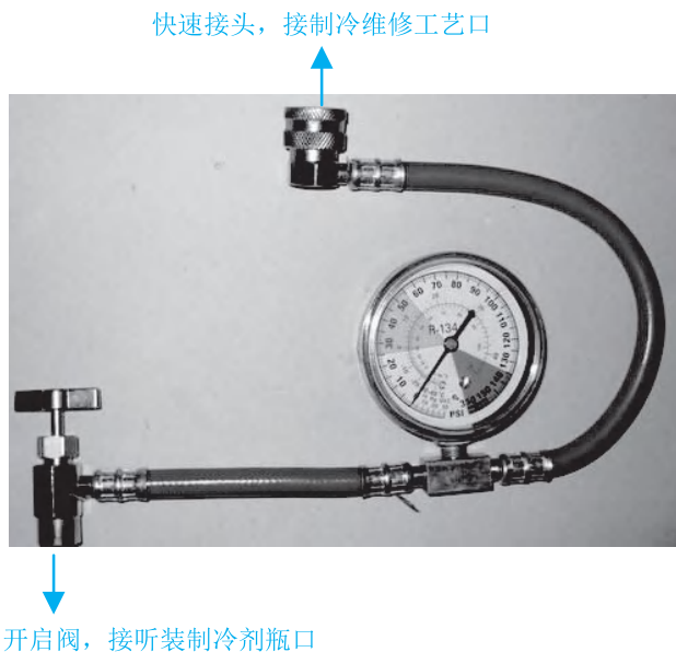
图 1-52 汽车空调简易充注工具
