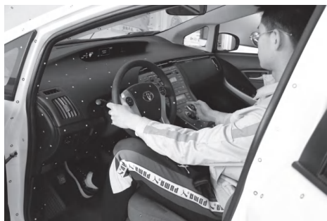
图 2-34 踩制动踏板，换挡到 N 挡
