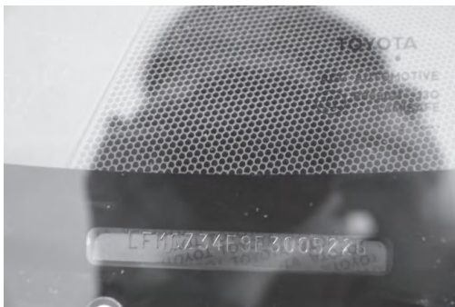
图 2-20 前风挡玻璃左下角 17 位 VIN 码
