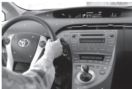
图 2-32 按一键按钮开关，打到点火挡
