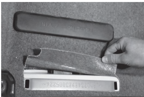
图 2-22 副驾驶座椅前部下侧 17 位 VIN 码
