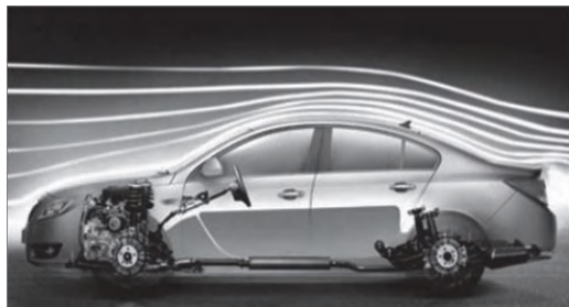
图 1-19 车身风洞实验的流线
