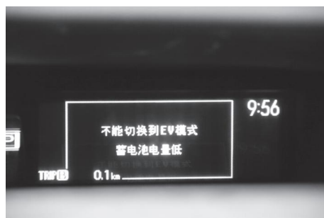
图 2-17 仪表信息显示 “不能切换到 EV 模式”
