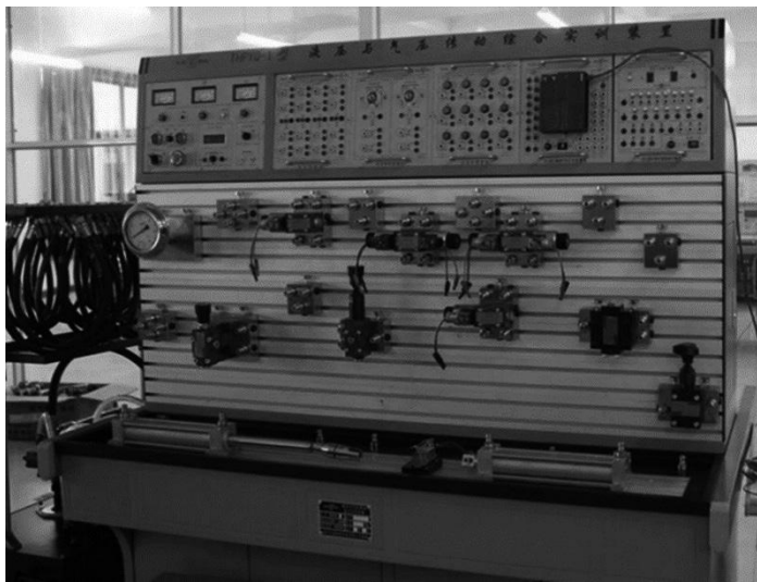
图 1-8 液压综合实验装置
