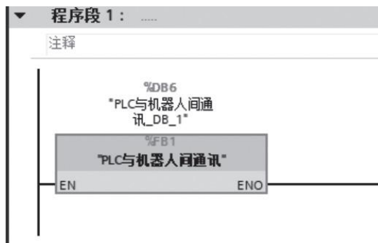
图 5-17 PLC 与机器人间通讯功能块调用
