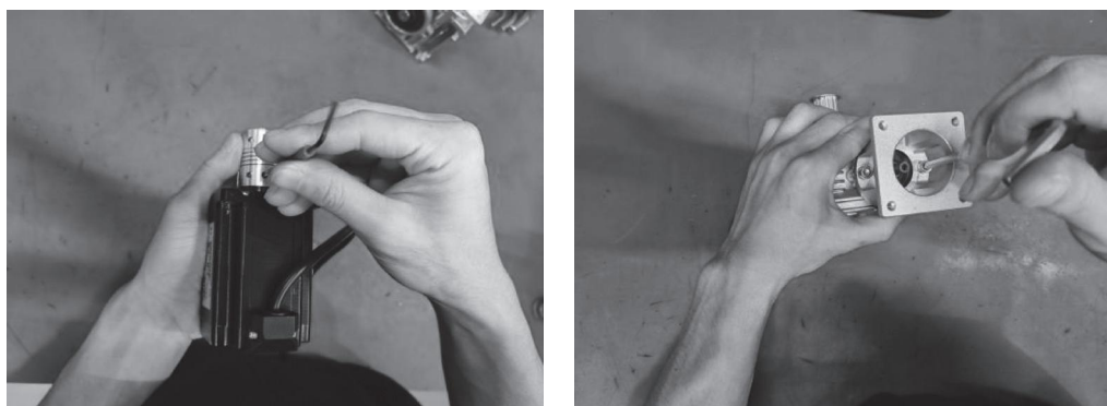
图 2-3-16 安装步进电机与联轴器, 安装蜗轮蜗杆减速机支架
