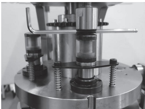
图 2-2-14 调整冲头高度
