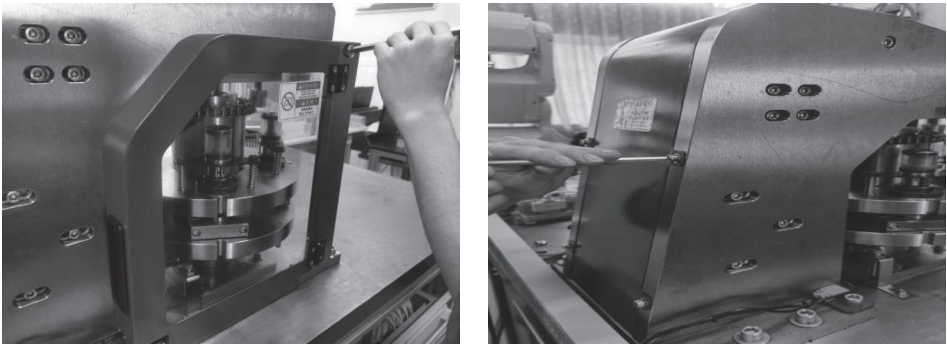
图 2-2-16 安装观察窗、防护罩
