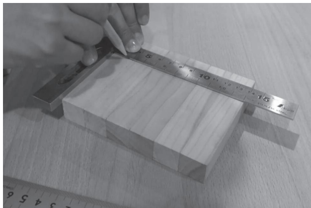
图 1-5 按照各构件图上的尺寸画线
