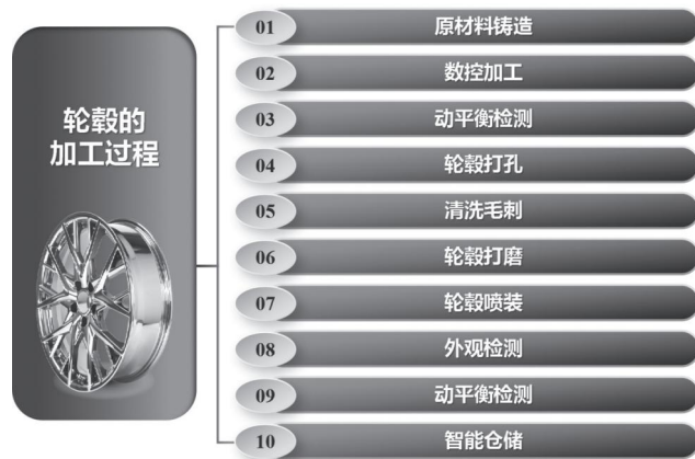
图 0-0-2 汽车轮毂加工工艺流程
