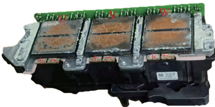
图 1-3-4 电机控制器 IGBT 功率模块
