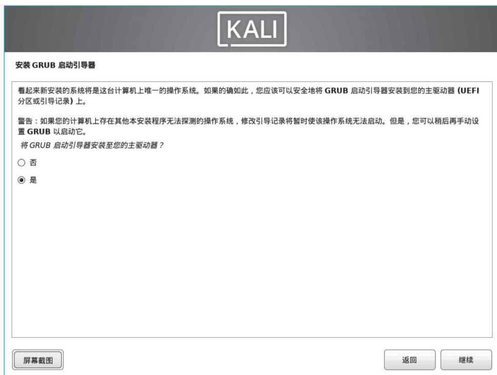
图 2-35 安装 GRUB 启动引导器
