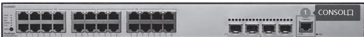
图 2-2 华为技术有限公司交换机 Console 口
