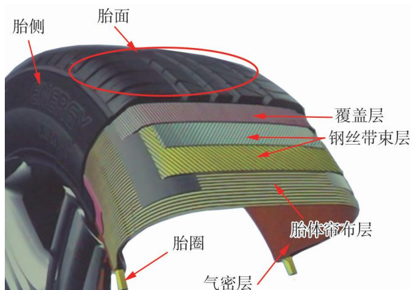
图 2-2-11 无内胎轮胎结构
