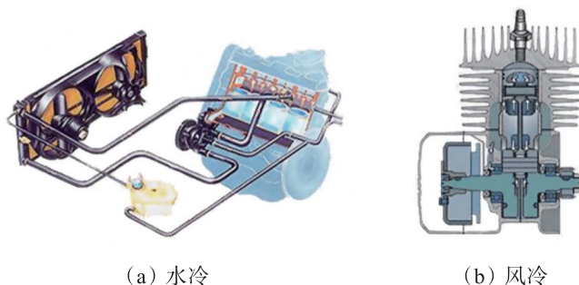
图 2-1-2 水冷和风冷内燃机示意图
