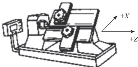
图 1-7 后置刀架坐标系
