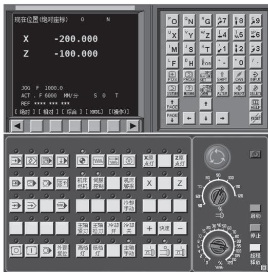
图 1-1 数控机床控制面板
