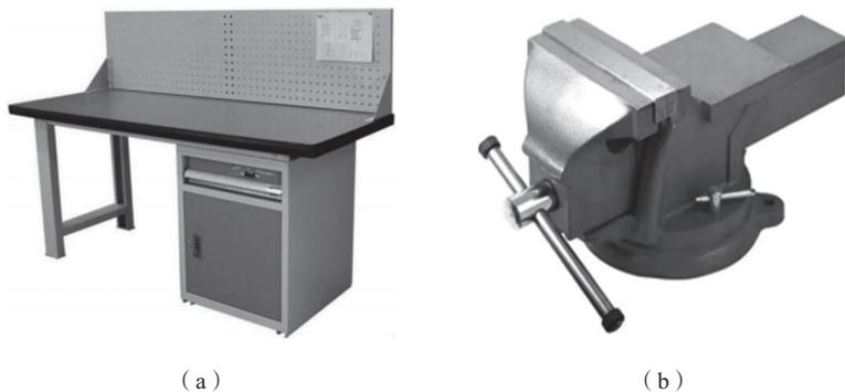
图 1-4 不锈钢工作台和回转式台虎钳
