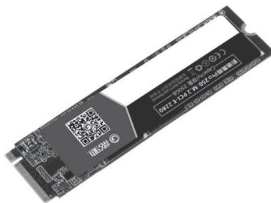
图 1-8 固态硬盘 (M.2 接口)
