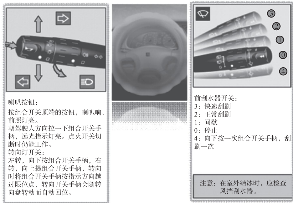
图 1-1-6 汽车常用的组合式开关
