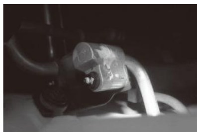
(b) 照射时显现漏点
