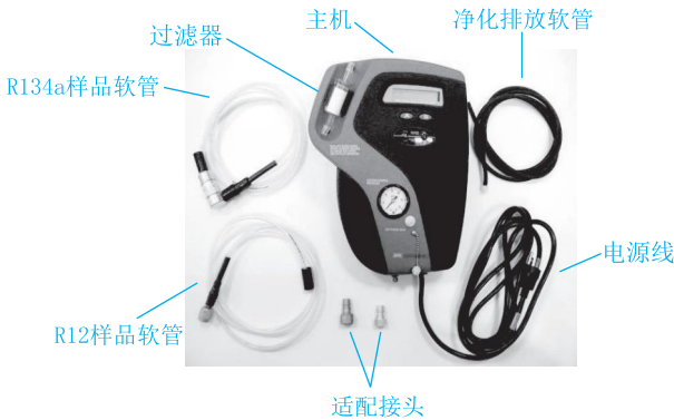
图 1-28 制冷剂鉴别仪
