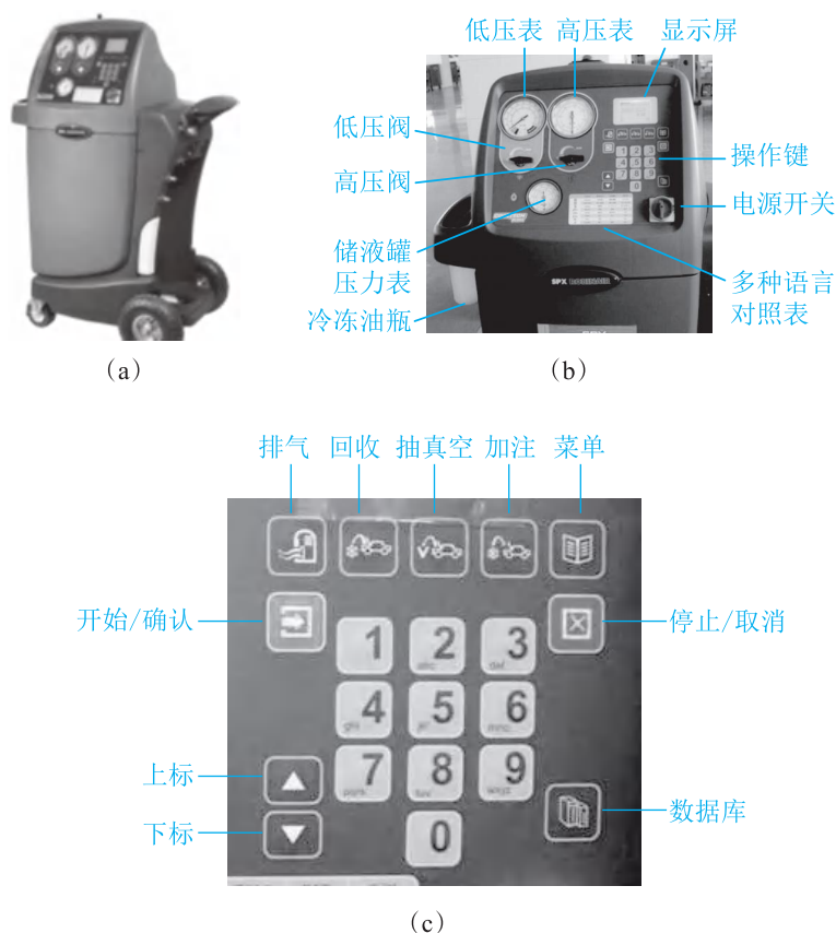
图 1-32 Robinair (AC350ZZ) 型回收加注机
