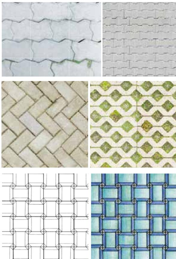
图 1-114 异形咬合砖的结构被解构为长方形网格
