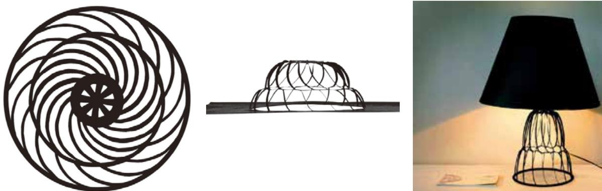
图 1-128 用圆形的拉伸形成两层塔式结构的灯座
