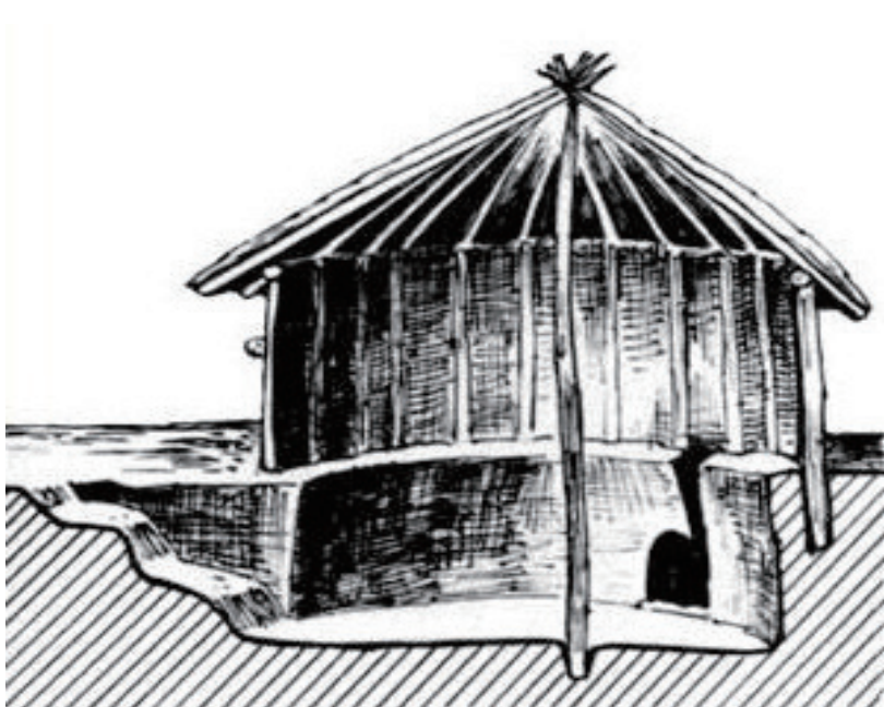
▲ 图 1-1-2 半地穴式建筑的平面图和剖面图
