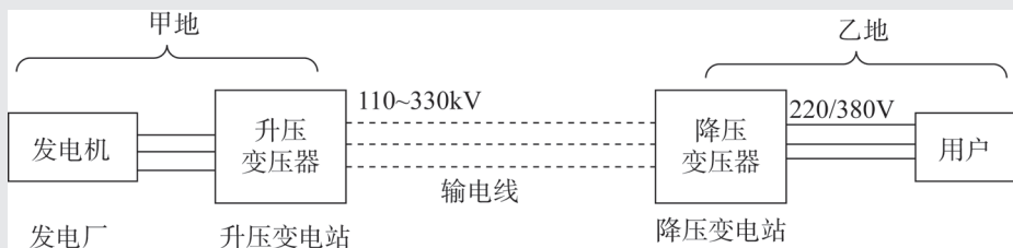
图1-8 高压输电过程
