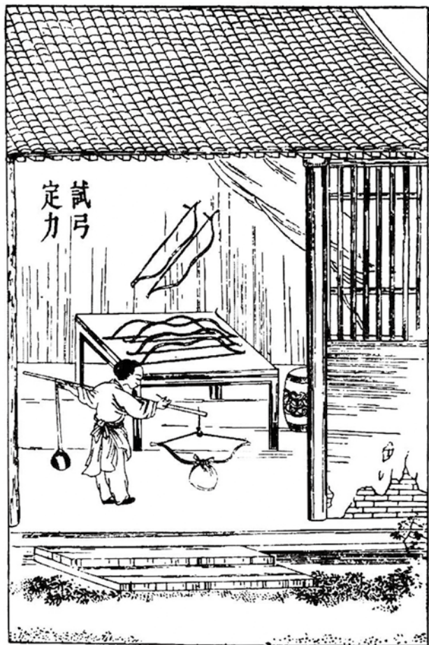
[明]宋应星《天工开物》中的试弓定力
