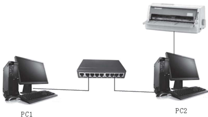
图 1-49 共享打印机网络拓扑图
