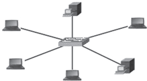
图 1-17 星型拓扑结构
