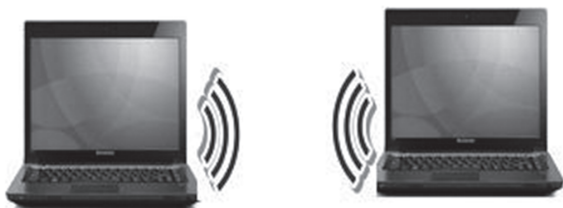
图 1-24 基于 Ad-Hoc 模式的无线对等网拓扑
