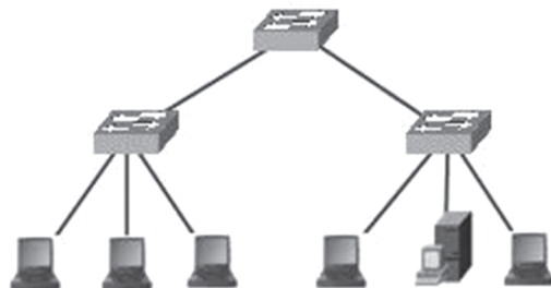
图 1-19 树型拓扑结构
