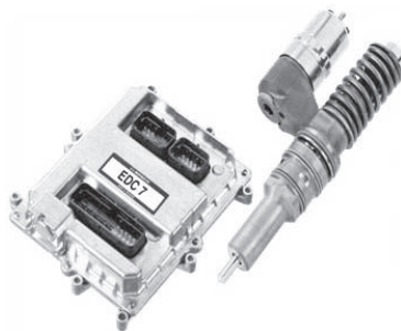
图 1-2 电控泵喷嘴系统
