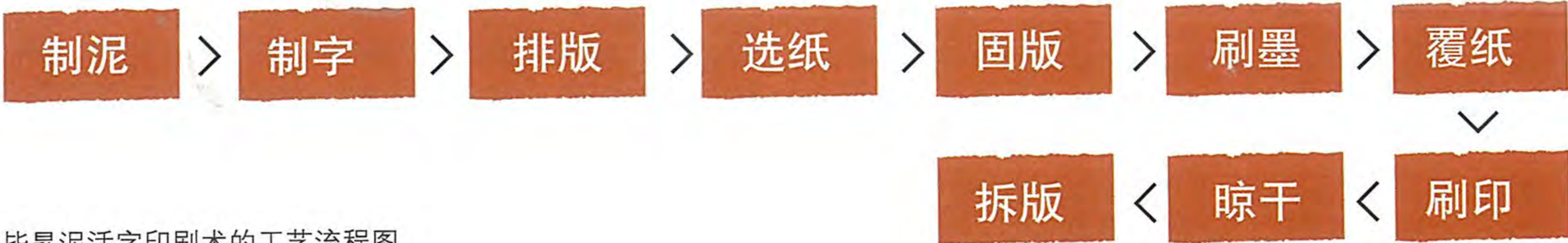
毕昇泥活字印刷术的工艺流程图
