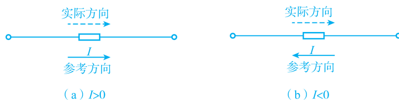
图 1-6 电流的参考方向与实际方向
