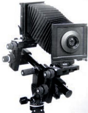
机背取景照相机的快门和光圈均设在镜头里，光圈可收缩到 F64 以上，整个镜头成为一个独立的组件，机身部分的最大特点就是镜头、后背（胶片部分）都可以升降、俯仰、左右转动、横向移动，在普通照相机上没有这种功能。
