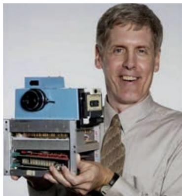
第一架实验性的电子静态视频照相机
