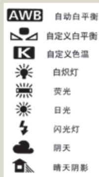
② 自定义白平衡: 将相机对着白纸按动“白平衡”设定按钮, 实现特定光源下的白平衡设定。
