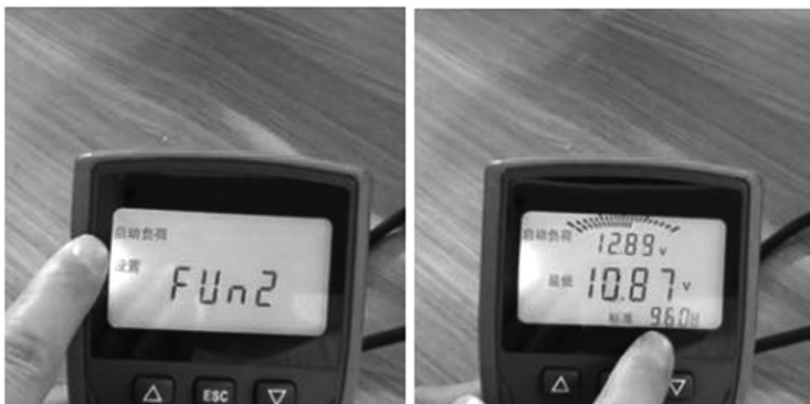
图1-1-8 测试蓄电池起动电压操作过程
