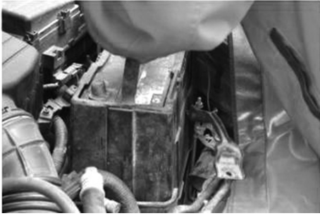
图1-2-12 取出废旧的蓄电池
