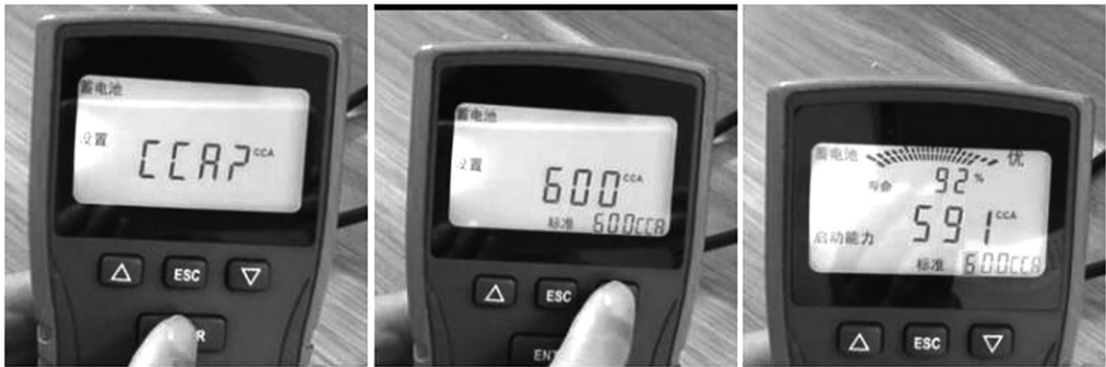
图1-1-7 测试蓄电池冷启动电流操作过程
