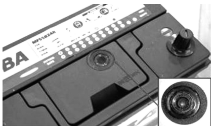
图1-2-7 带内装式密度计的免维护蓄电池
