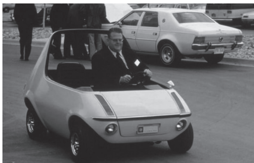
图 1-4 1969 年通用的微型混合动力实验车 512 系列
