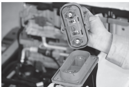
图 2-7 拔下内置保险丝的检修塞插头
