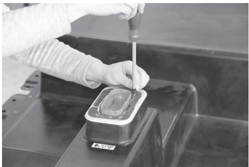
图 2-8 取下电池箱检修塞位置的4个沉头螺栓
