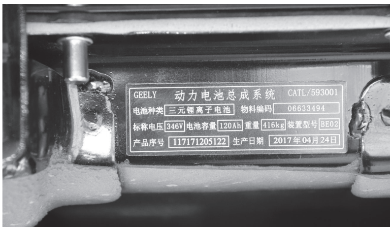
图 2-4 吉利 EV300 纯电动汽车的电池箱铭牌
