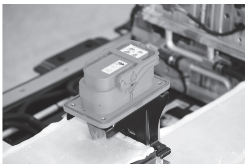
图 2-6 内置保险丝的检修塞插头位置
