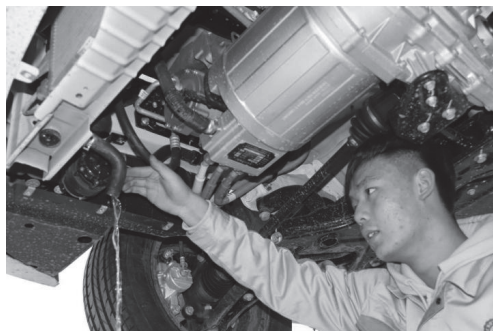
图 1-4 放出冷却系统的冷却液
