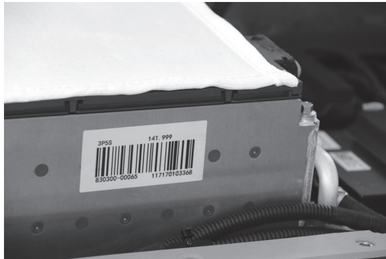
图 2-11 电池的串并联 (三并五串型)
