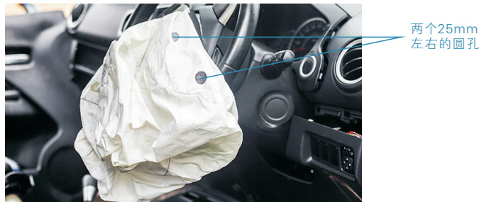
图 1-4 气囊背面开有两个直径为 25mm 左右的圆孔
