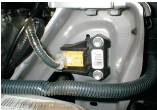
图 1-9 安装在发动机舱前纵梁上的机电式碰撞传感器
