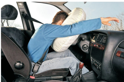
图 1-2 安全气囊的保护作用
