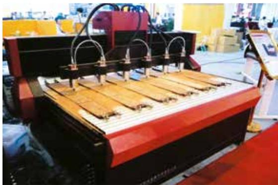
可同时加工多块材料的数控多头雕刻机
