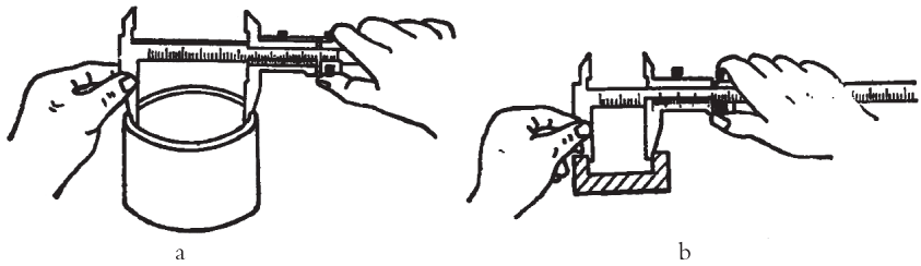
图2-20 测量孔径和槽宽度尺寸大的工件
