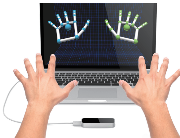
图 1-2-4 Leap Motion 手势捕捉设备
