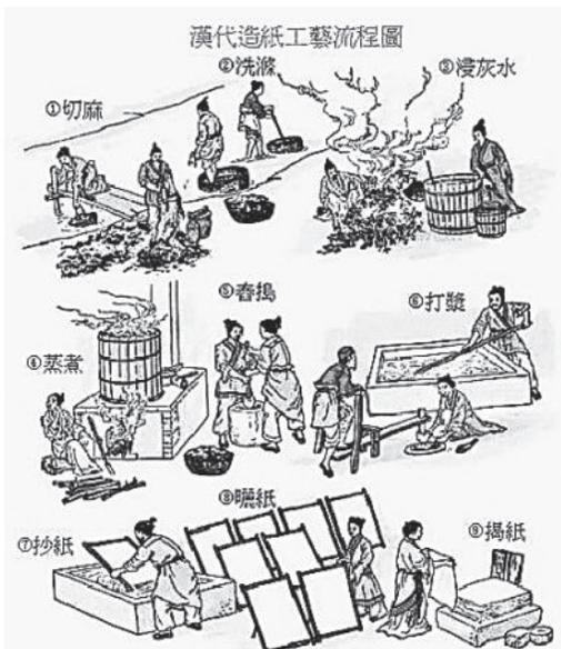
图 1-2-8 汉代造纸流程图
